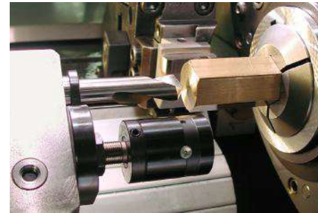
Dispositivo combinato doppio per fermo barra e portautensile (installabile in più stazioni)
