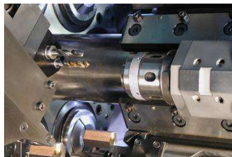
Mandrino sincronizzato con slitta supplementare per lavorazioni posteriori
