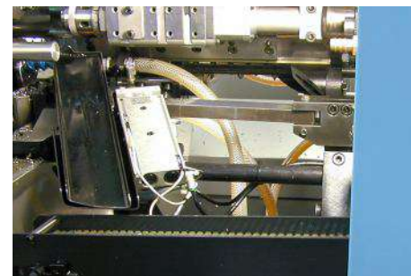
Scivolo pneumatico e nastro di trasporto pezzi lavorati
